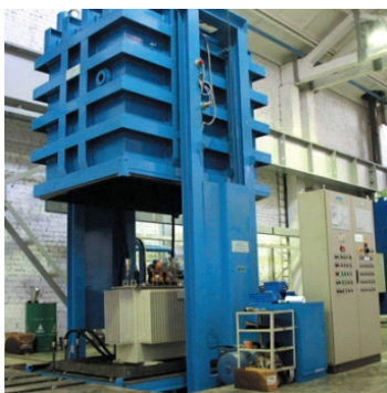
Вакуумная камера заливки масла
