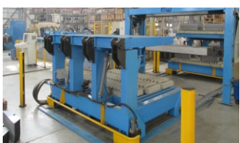
Линия поперечного раскроя электротехнической стали с раскладчиками
